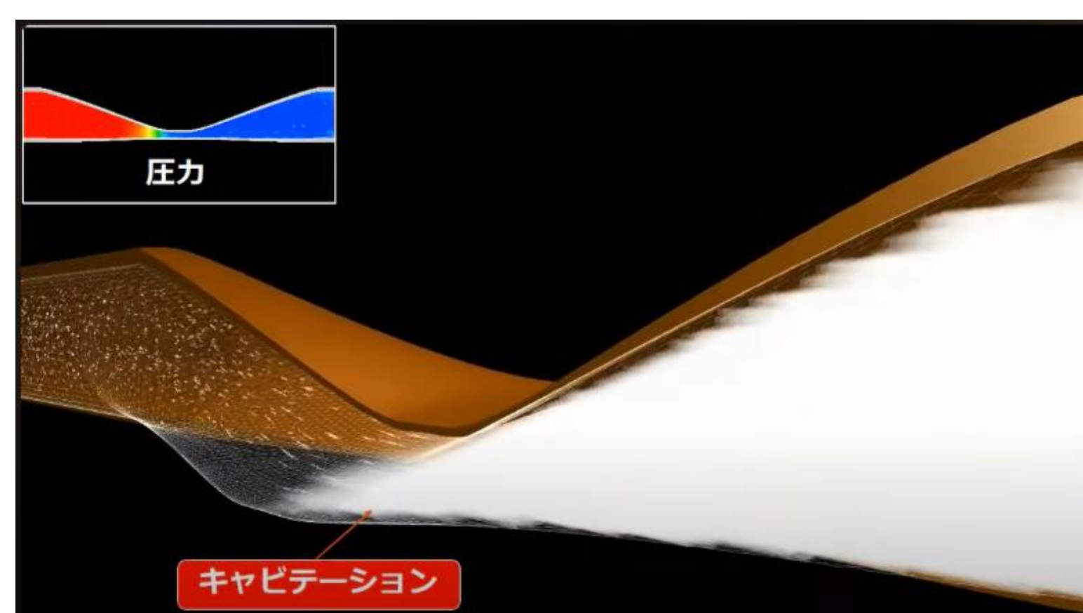
図1,2：圧力平常時(左) 低圧/キャビテーション発生時(右)
